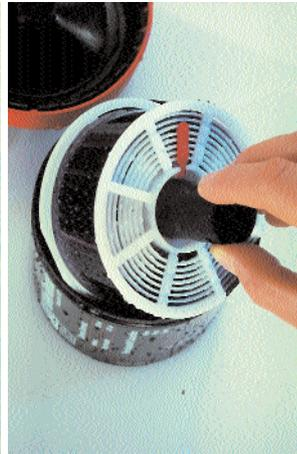
Nach fünf Minuten öffnen Sie die Dose und entnehmen die Spirale.
