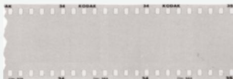
► Der Film ist klar, nur die Schrift auf der Perforation ist zu lesen: Sie haben einen unbelichteten Film korrekt entwickelt.
