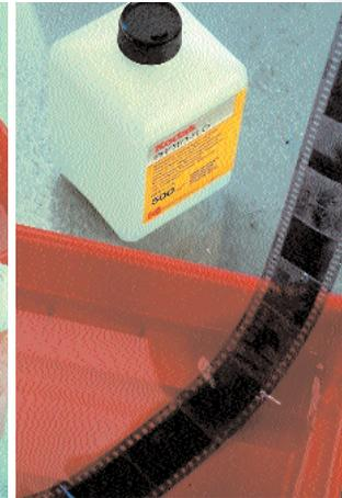
Ziehen Sie den Film jetzt langsam durch eine Schale mit Netzmittelbad.
