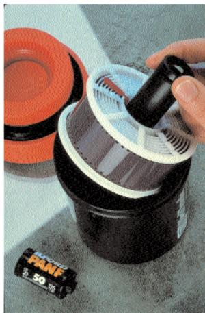
Dann verschwinden Film und Spirale in der Entwicklerdose, Deckel schließen.
