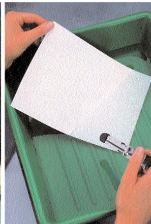
Mit einer Probestreifenreihe ermitteln Sie die korrekte Belichtungszeit.
