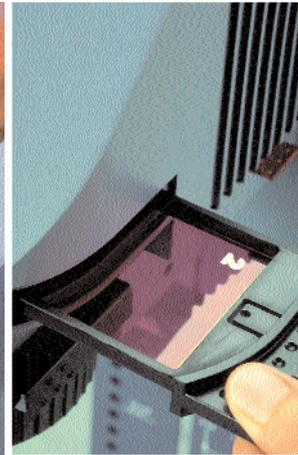
Dann können Sie das Multigrade-Filter mit der Gradation 2 in die Filterschublade ...
