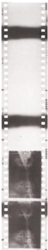
Legen Sie den Kodak Infrared wirklich nur bei absoluter Dunkelheit in die Kamera. Sonst ist er nach dem Entwickeln mit schwarzen Streifen übersät.
