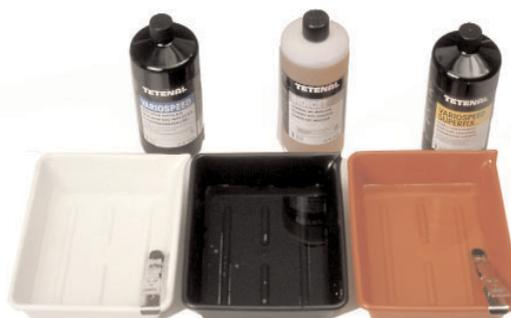
... und der Nassarbeitsplatz mit Schalen für Entwickler, Stoppbad und Fixierer.
