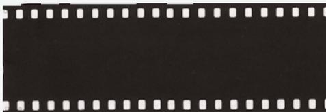
► Der ganze Film, einschließlich der Perforation, ist schwarz oder stark geschwärzt: Sie haben Lichtprobleme. Der Film wurde vor dem Entwickeln oder während des Entwickelns belichtet. Volles Schwarz deutet auf Tageslicht hin, ein Grauschleier kann auch schon durch eine versehentlich eingeschaltete Sicherheitsleuchte kommen.
